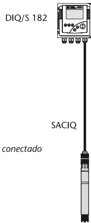
Transmisor de 2 canales con 4 salidas analógicas (juego de DIQ/S 182 y DIQ/CR3) con 2 sensores conectados
